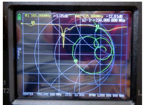
図 7 銅パイプアンテナのリターンロス測定
