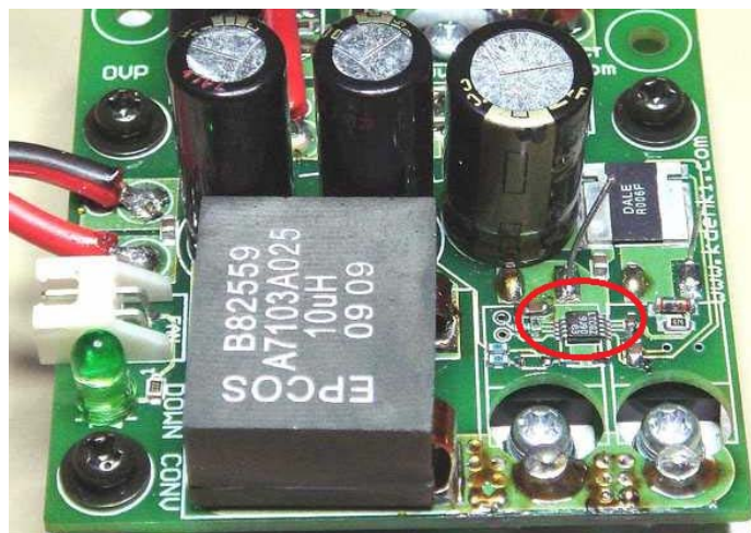
図2 ダウンコンバータ基板 H35×W60×D50 赤囲み部分がLTC3824
