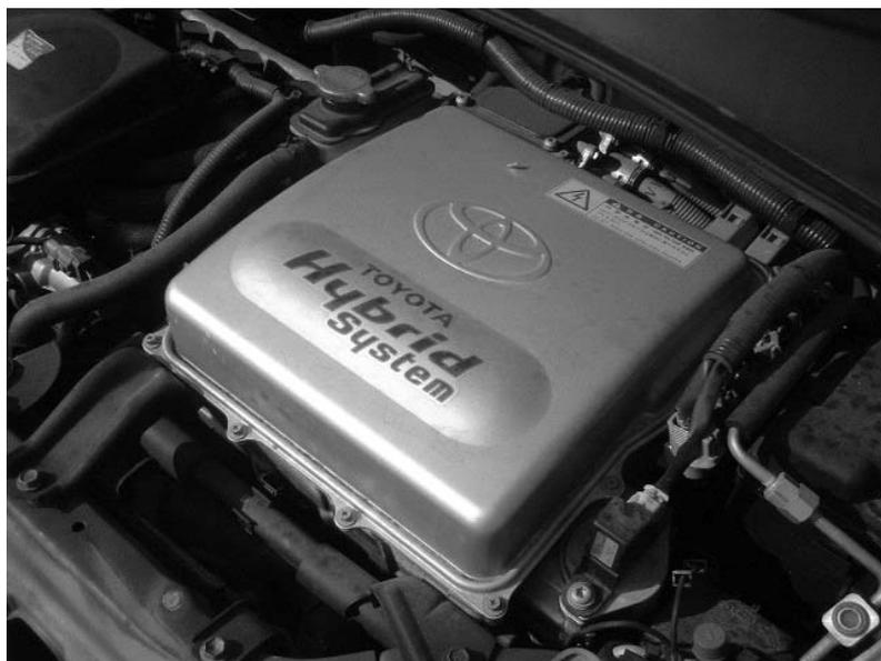
図3 初期型プリウス NHW10 型のインバータ写真
