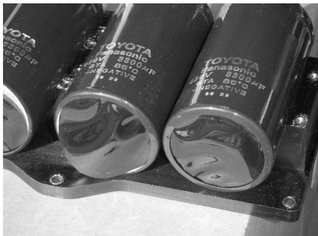
図11 トップカバーが変形、脱落
